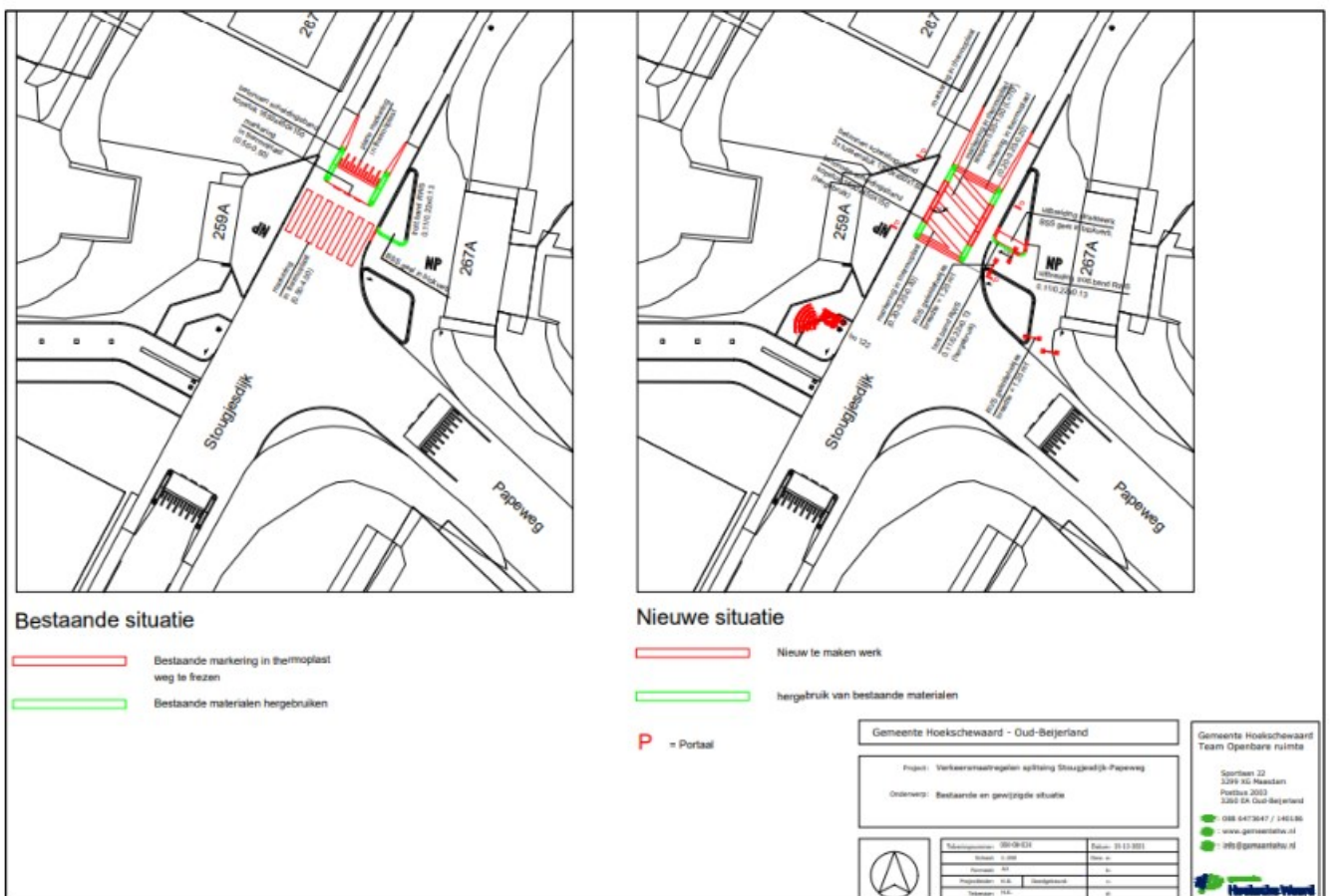
Afbeelding: Technische tekening infrastructurele aanpassingen (links: Huidige situatie, rechts: Toekomstige situatie)
