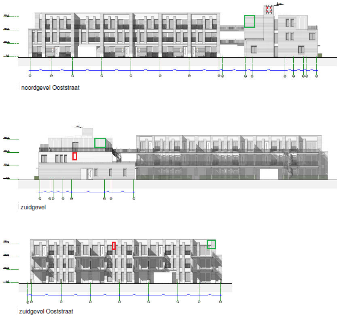
Figuur 4.7 Schetstekening nieuwbouw noord- en zuidgevels inclusief de locaties voor de inbouwkasten (rood) en de vleermuisvriendelijke spouwmuur (groen) aan de Ooststraat 78-82 te Oud-Beijerland.
