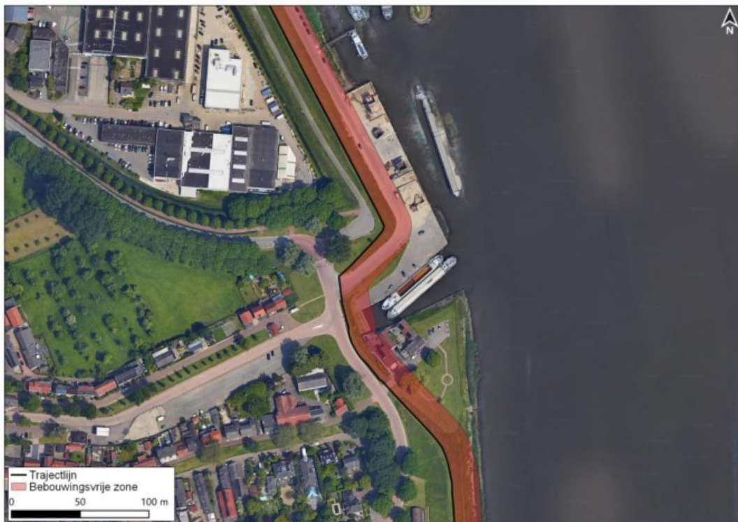
Afbeelding 3.5 Bebouwingsvrije zone aan de buitendijkse zijde van de dijk (conservatieve breedte 20 m)
