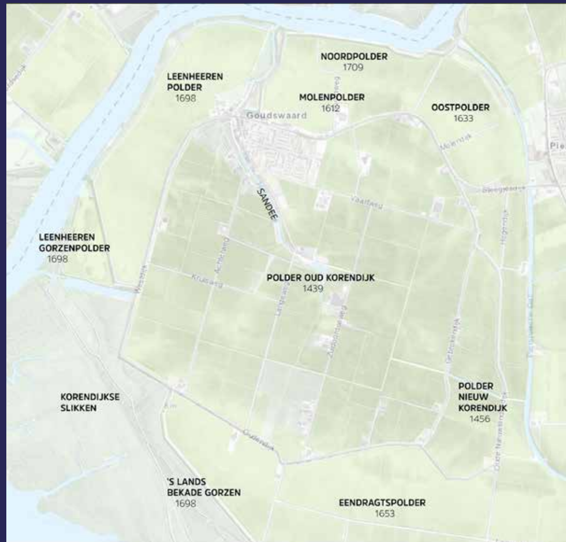
Afb 3.15 Overzicht van de polder Oud-Korendijk en de omliggende polders, inclusief hun jaar van inpoldering
