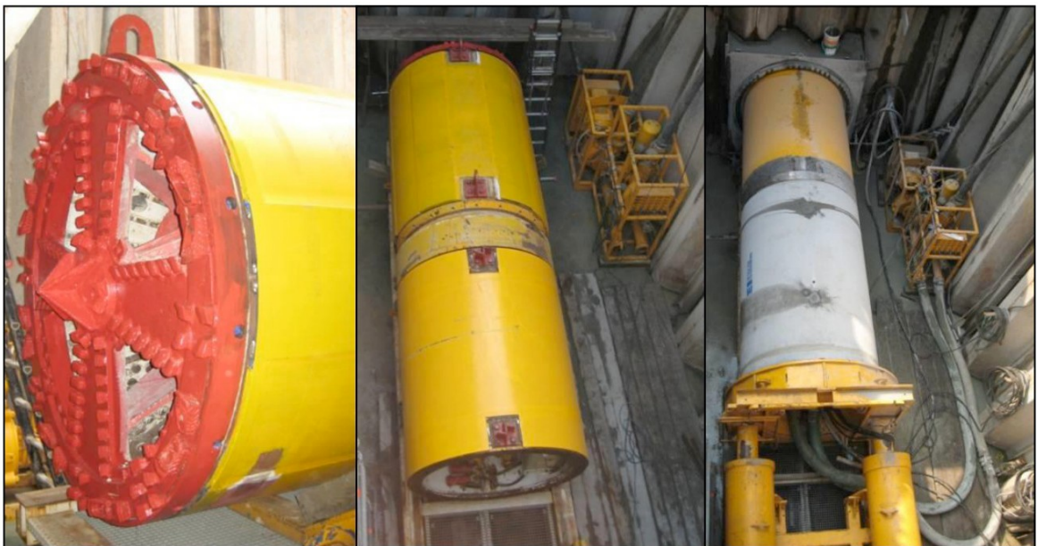
Figuur 1: Snijmes met beitels -- Boorkop -- Boorkop met betonnen productbuis Ø1600/1940mm
