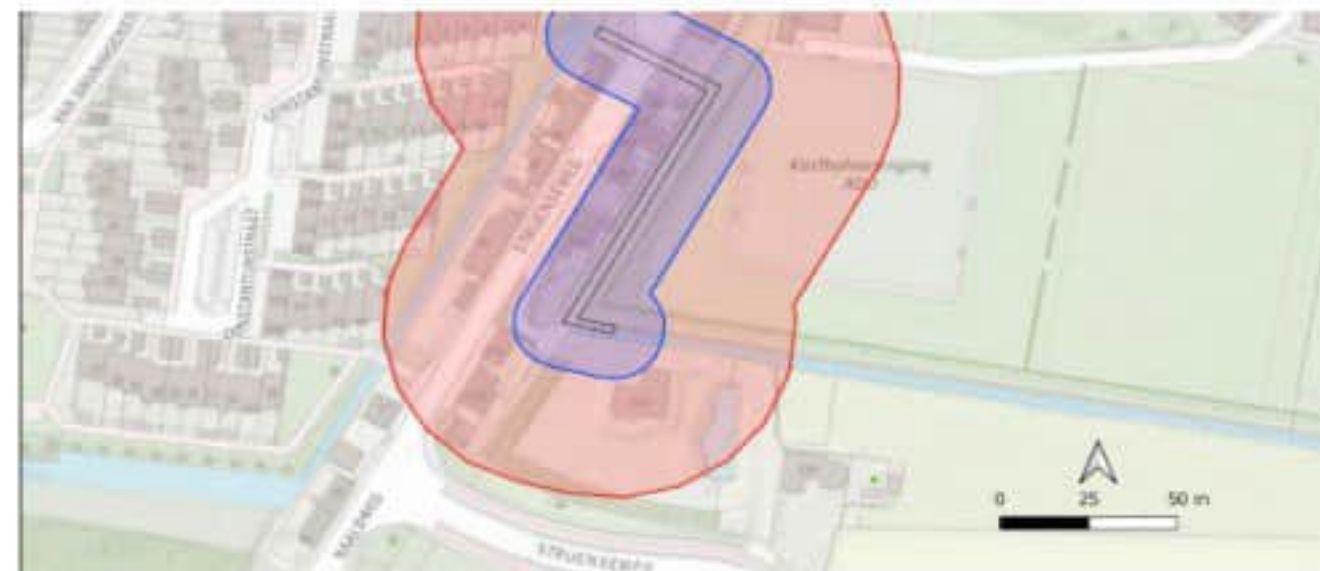
Figuur 3.2: Maximale invloedsgebied van de freatische bemaling uitgaande van duur van 6 dagen per sleufdeel van 75 meter (rood = invloedsgebied GHG, blauw = verlaging onder GLG)
