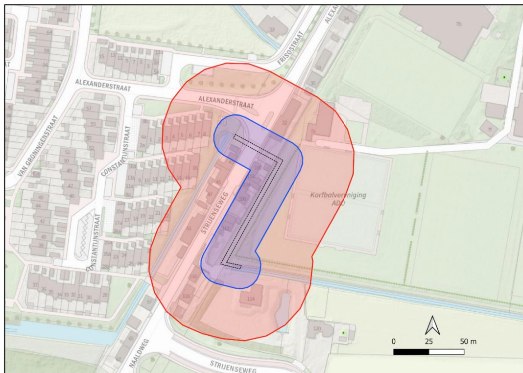
Figuur 3.2: Maximale invloedsgebied van de freatische bemaling uitgaande van duur van 20 dagen per sleufdeel van 75 meter (rood = invloedsgebied GHG, blauw = verlaging onder GLG)
